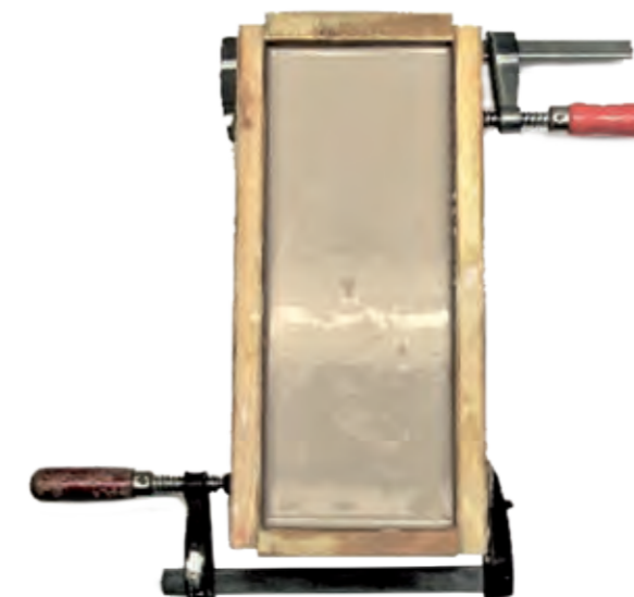
Gips ohne Lufteinschlüsse eingießen, Blasen entfernen, und aushärten lassen.
