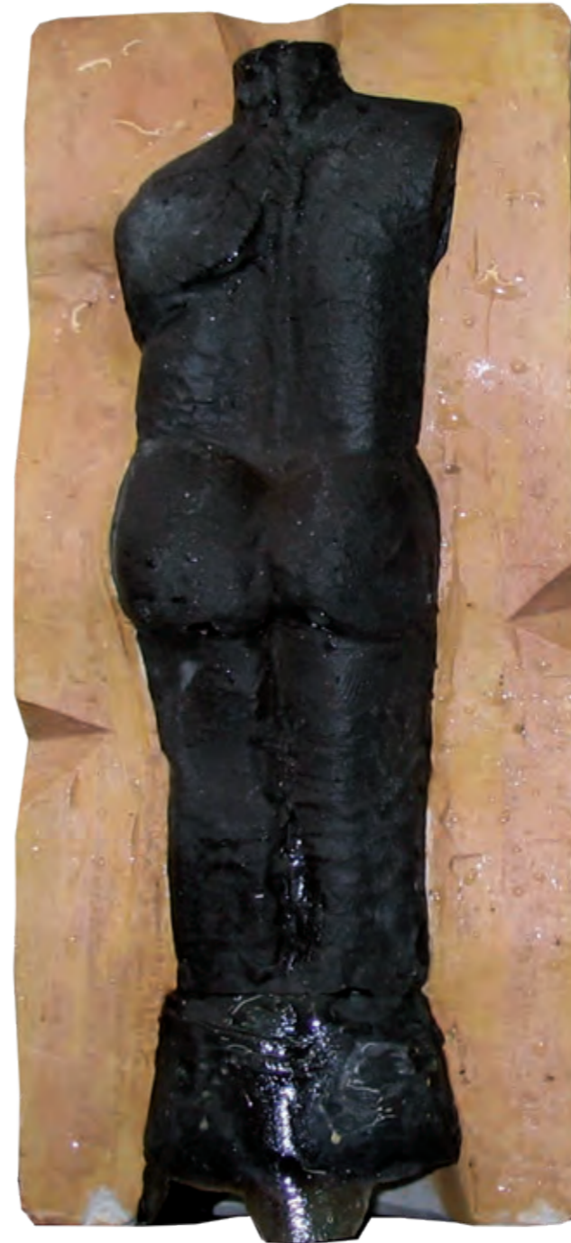
Die geöffnete Gipsform mit der erkalteten Wachsfigur
